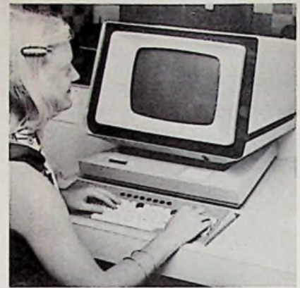
Bild 2. Bei diesem Video-Display sind Gehäuse und Frontblende aus Strukturschaum
